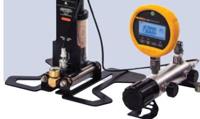
El kit de la bomba está diseñado para que el colector de calibración se conecte y desconecte fácilmente por medio de pasadores de retención rápidos.
